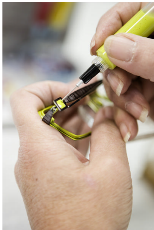
Pose de Résine à l'aide d'une seringue sur le modèle YC 2190
